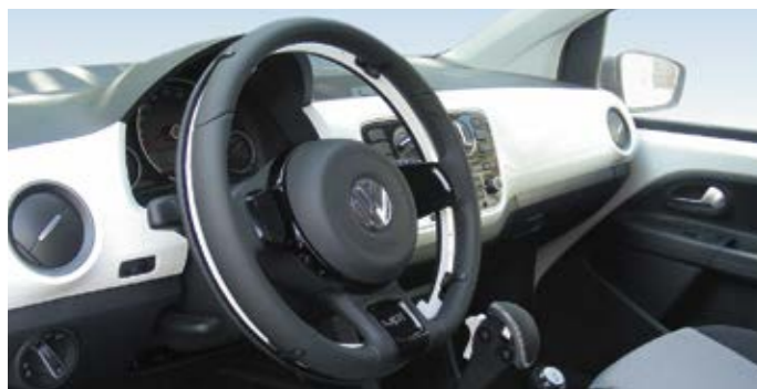
Acceleratore elettronico rotativo sotto il volante "Ghost" e freno di servizio a leva verticale. Codici comunitari 25.04 – 20.06
